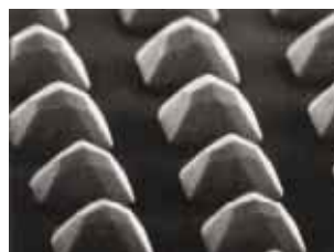
図1. 選択成長により作製したInGaAsドットアレイ。
